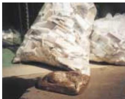
鋳物で利用された発泡型を20kgのインゴットに減容
