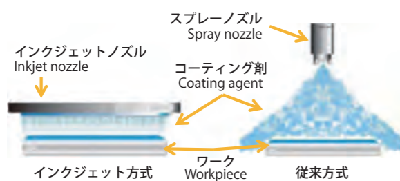
インクジェット方式による塗料削減
