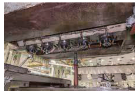
5つ同時に加工できるスイス製の機械。製造元では生産中止になり、レトロフィットで再生された。
