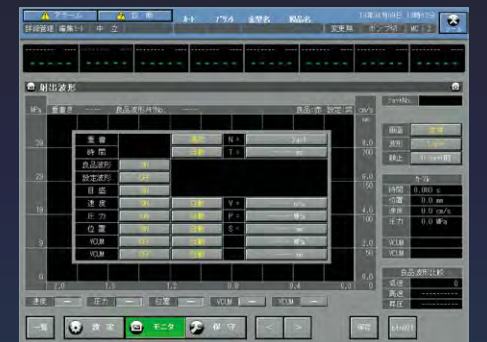
各波形の表示選択とスケール設定が可能 Select display of each waveform;set its scale.
