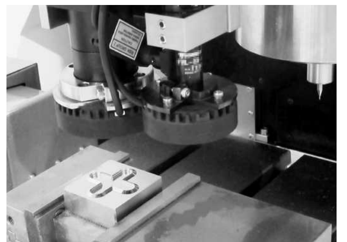
写真2 撮像式機上計測装置
