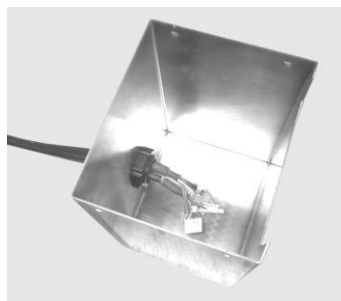
樹脂ナットを締め付け、 モータカバーに取り付けます。
