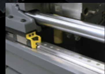
リニアガイド支持機構 Linear guide support mechanism
