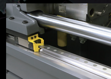
無給脂リニアガイド支持機構 Non-lubricated linear guide support mechanism
