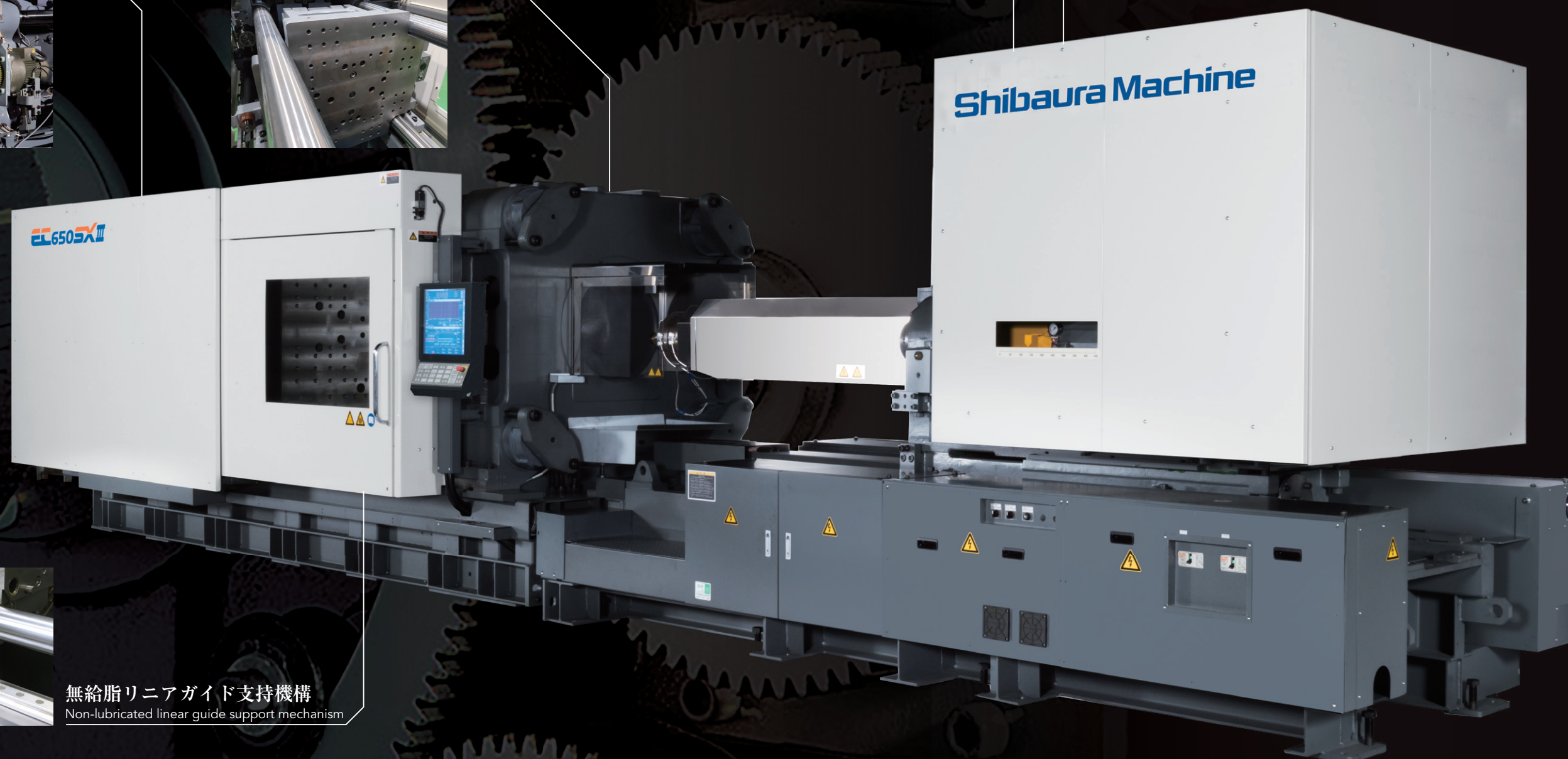
タイバーブッシュレス・ ダブル剛体プレート構造 Tie Bar Bushless Double Rigid Plate Structure
