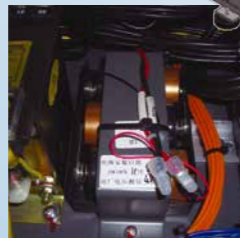
エンコーダバックアップ電池の交換
