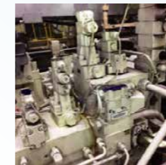
ポンプ圧力・射出速度 確認、調整(OP)
